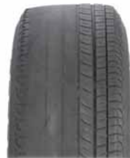
Λανθασμένη Ευθυγράμμιση Τροχών
