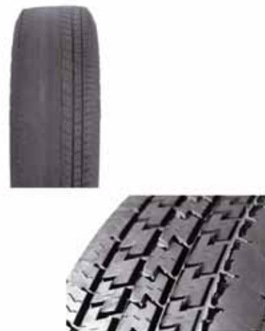
Λανθασμένη Ευθυγράμμιση Τροχών
